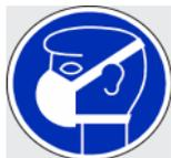
Die Einhaltung der Arbeitsgrenzwerte ist durch wirksame staubtechnische Massnahmen, z. B. lokale Absaugeinrichtungen, sicherzustellen. Besteht die Gefahr einer Überschreitung der Expositionsgrenzwerte, z. B. beim offenen Hantieren mit dem pulverförmigen trockenen Produkt oder beim Verarbeiten durch Spritzen, so ist eine geeignete Atemschutzmaske zu verwenden.
