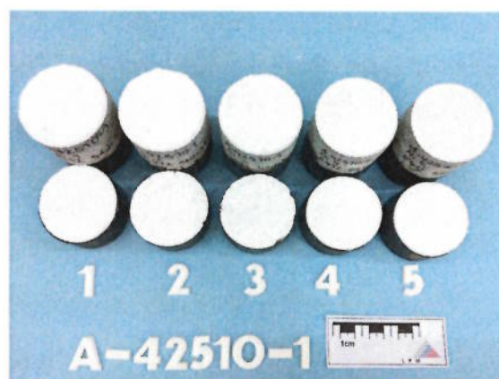
Foto 2: Bruchbilder nach Abreissprüfung - 56 Tage
