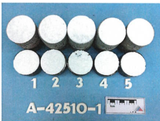
Foto 1: Bruchbilder nach Abreissprüfung - 28 Tage
